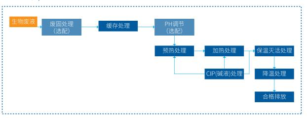
运行流程:生物废液经由废固处理单元(选配)进入缓存单元,通过泵输送至换热单元及加热单元内加 热至灭菌温度,加热的废液进入循环保温单元内在规定温度下保持设定时间后达到灭菌效果,循环降温后排 放,系统内废液持续排放,无滞留状态。
