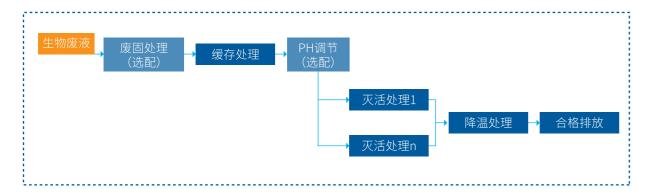
生物废液经由废固处理单元(选配)进入缓存单元,通过泵输送至灭活单元1中,待灭活单元1达到液位设定后,废液进入灭活单元2中,灭活单元1加热至灭菌温度,维持设定时间进行灭活处理,废液灭活后进入降温单元循环降温后排放,排放后罐体内可进行CIP清洗操作处理,灭活单元1与灭活单元2批次运行,持续进行废液灭活处理。
