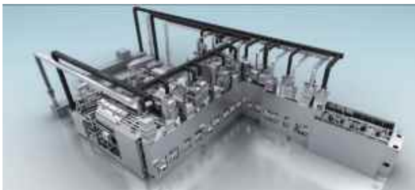
西林瓶水剂与冻干共线 T 型布局生产案例
